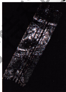
左图: 8.4 \mu m/11.8 \mu m 光谱比值显示出丰富的石英迹象 右图: 在 LandSat 卫星图片背景下阈值比
