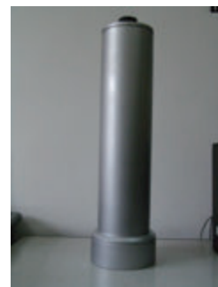
用于低比辐射率样品测量的黑体筒
